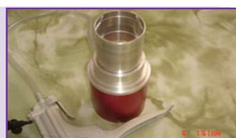
4. चिम्टालाई लाइटरले निर्मलिकरणगर्ने र मेम्ब्रेन फिल्टरलाई चिम्टाको सहायताले निकाली एक हातमालिई अर्को हातले फिल्टर कपलाई उठाई फिल्टर पेपर राखेर राम्रोसंग कर्ने ।
