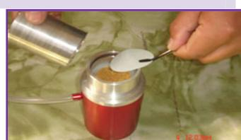
5. आवश्यकतानुसार १००मि.लि.(प्रशोधितपानीभएमा) अथवा ५०वा १०मि.लि. (अप्रशोधितपानीभएमा ) फिल्टर कपमा राखीपम्पले तानेर फिल्टर गर्ने । १००, ५० र १० मि.लि. को चिन्ह फिल्टर कपमाकोरिएको हुन्छ ।
